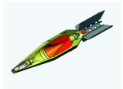
ill. 1 Vue en coupe d'un projectile 90MM à charge creuse
