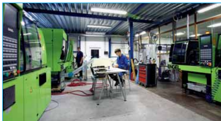
Le nouveau centre, équipé des presses ENGEL de 25, 80 et 150 tonnes, permet de réaliser des essais, des mises au point, des tests et des préséries.
