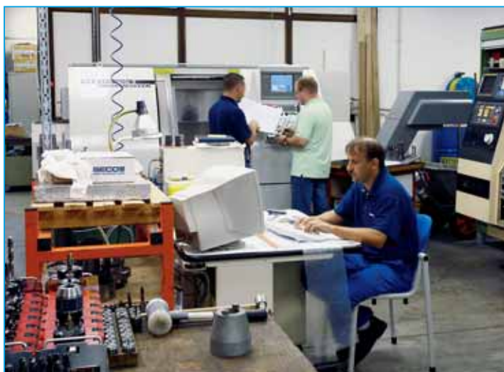
Pour la fabrication d'une matrice, on introduit le modèle CAO 3D dans MasterCam afin de réaliser les programmes FAO pour la fraiseuse ou la machine d'électro-érosion. Photo de droite : vue de l'UGV Deckel CN 70 pouvant atteindre 42000 tours/minute.
