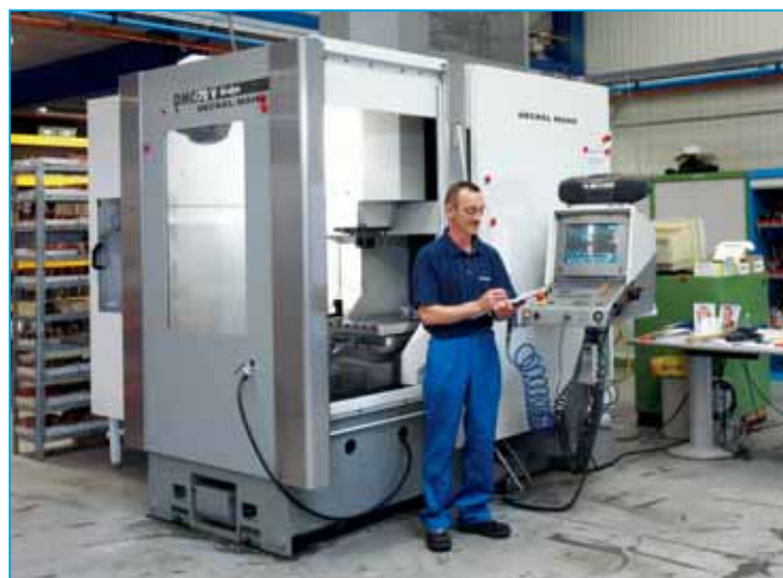
Pour la fabrication d'une matrice, on introduit le modèle CAO 3D dans MasterCam afin de réaliser les programmes FAO pour la fraiseuse ou la machine d'électro-érosion. Photo de droite : vue de l'UGV Deckel CN 70 pouvant atteindre 42000 tours/minute.
